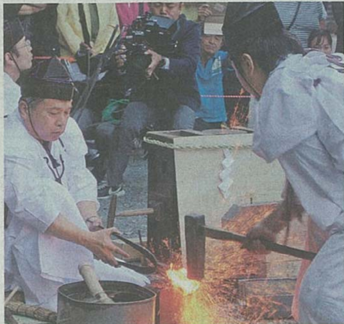
1300度に熱した玉鋼を大づちでたたき、刀匠たち＝桑名市多度町の多度大社で
